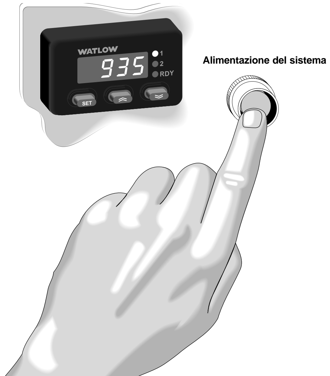
Figura 3 - Inizio funzione di controllo
