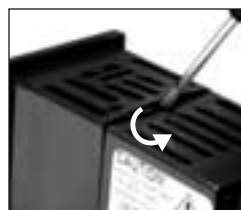
Figura 2 — Movimento di rotazione del cacciavite sulle parti superiore e inferiore
